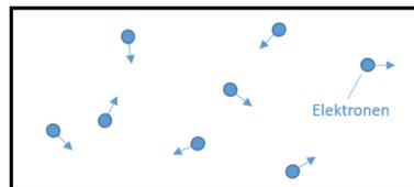
Ursache des Rauschens ist die thermische Energie der Elektronen. Abhängig von ihrer Temperatur bewegen sich die Elektronen mit einer bestimmten Geschwindigkeitsverteilung durch das Material und stoßen an dessen Wänden hin und her. Diese Bewegung der Elektronen führt bei der Spannungsmessung an einem Widerstand zu einer zusätzlichen, fluktuierenden Spannung (dem Rauschen).
