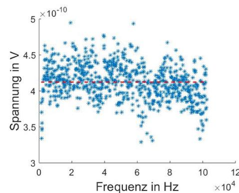
In der obigen Abbildung ist eine Messung des Spannungsabfalls an einem Widerstand für verschiedene Frequenzen gezeigt. Die rote Linie zeigt den ohmschen Widerstand und die darum verteilten Punkte zeigen die Spannungsmessungen mit Rauschen. Aus den auf diese Art und Weise erzeugten zufälligen Zahlen lässt sich jetzt ganz einfach ein Binärcode aus Zufallszahlen erstellen.
