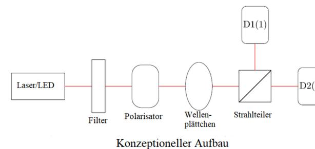
Im dargestellten Aufbau wird von den Detektoren zusätzlich der zeitliche Verlauf der Photonen-Detektionen aufgenommen, um aus deren Differenz die Ankunftszeiten zu berechnen.
